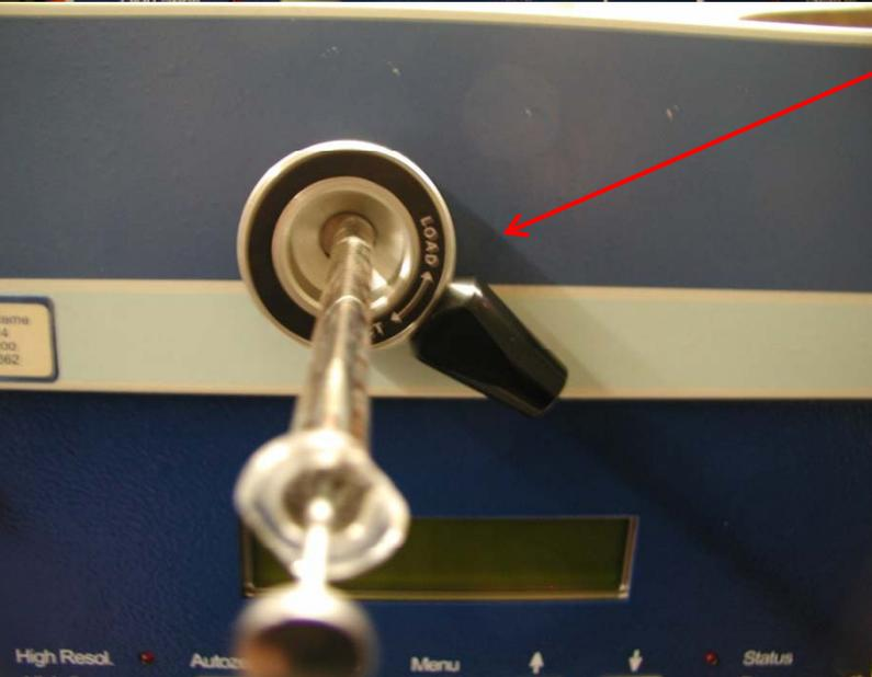
Um eine Messung zu starten muss der Hebel des Injektionsventils in Richtung INJECT ungelegt werden.
